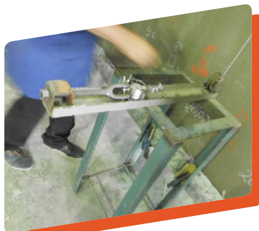
Foto 2: Aplicação de carga no dispositivo de carga faceando a parede.
