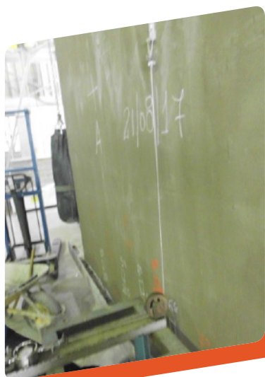
Foto 1: Ensaio de cargas suspensas de carga faceando a parede.
