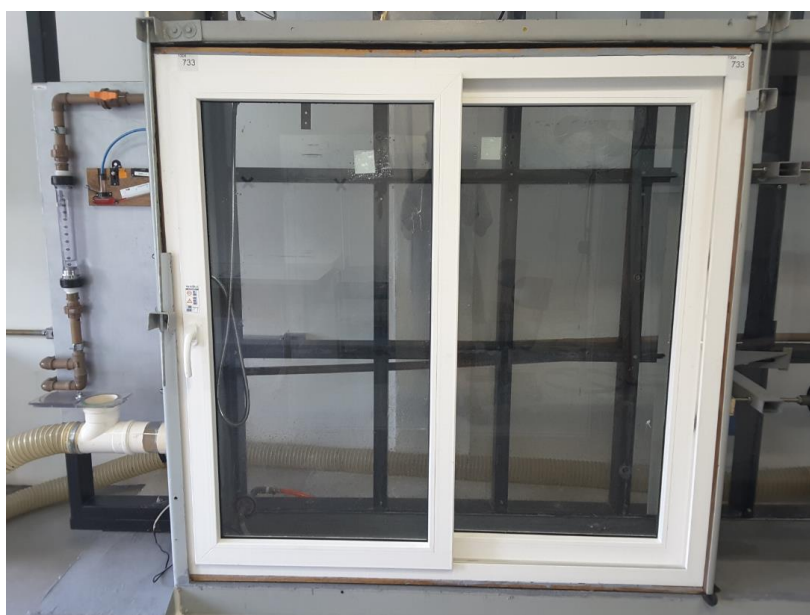
Figura 10 – Execução do ensaio de estanqueidade à água
