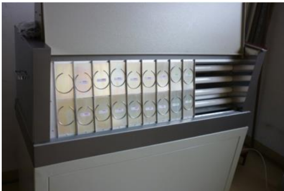
Figura 19 – Câmara de UV para avaliação da durabilidade do composto de PVC
