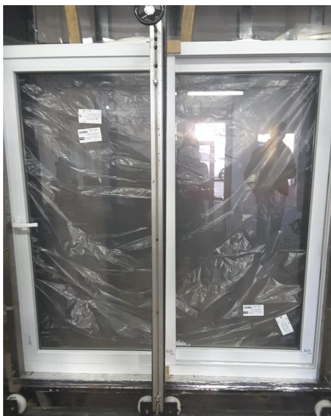
Figura 9 – Execução do ensaio de permeabilidade ao ar
