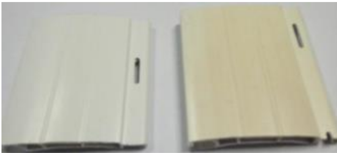
Figura 18 – Perfil de palheta de persiana padrão (esquerda) e após exposição em câmara de weather-o-meter (direita)
