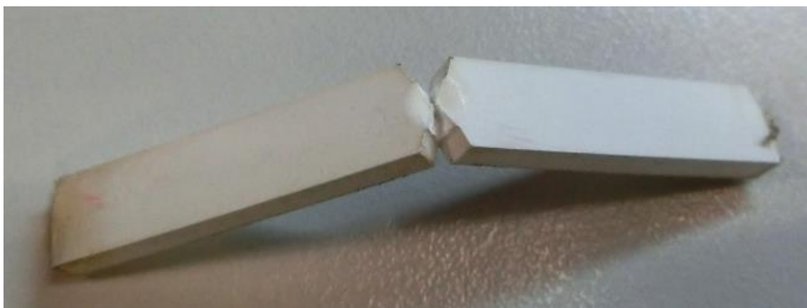
Figura 20 – Corpo de prova submetido ao ensaio de verificação da resistência ao impacto Charpy após exposição em câmara de UV
