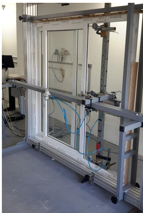
Figura 5 – Execução do ensaio de verificação do comportamento sob ações repetidas de abertura e fechamento
