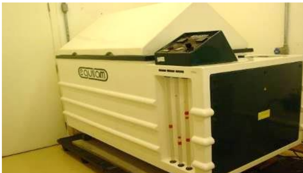
Figura 21 – Detalhe da câmara de névoa salina neutra onde roldanas e parafusos são submetidos ao ensaio de verificação da resistência à corrosão
