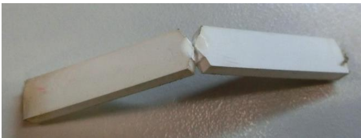
Figura 22 – Corpo de prova submetido ao ensaio de verificação da resistência ao impacto Charpy após exposição em câmara de UV
