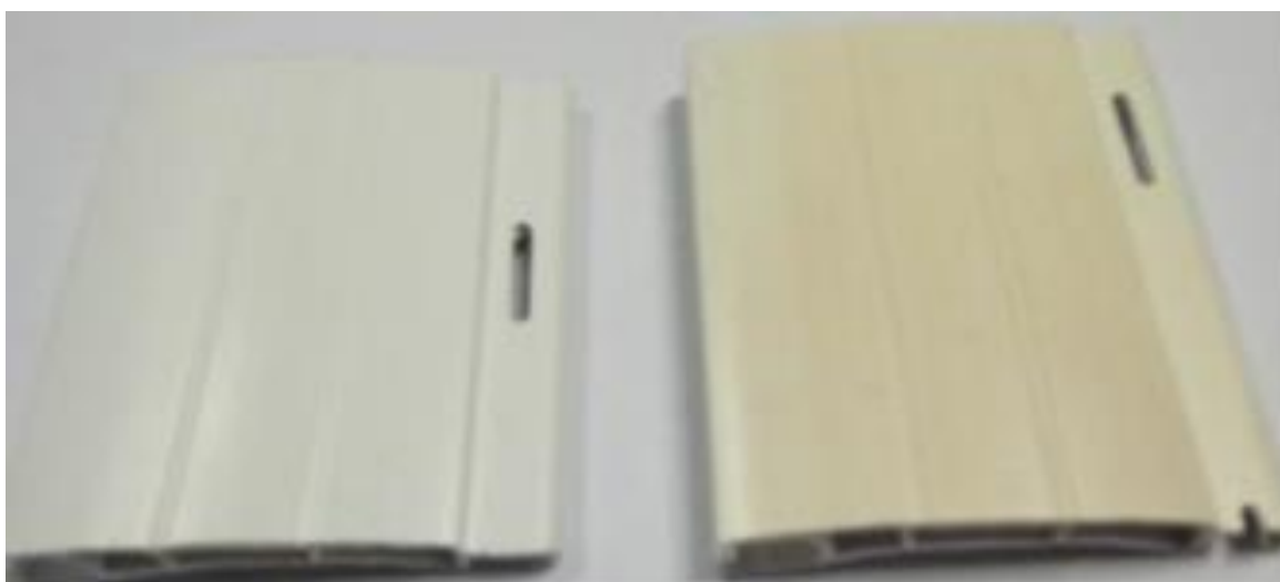
Figura 20 – Perfil de palheta de persiana padrão (esquerda) e após exposição em câmara de weather-o-meter (direita)
