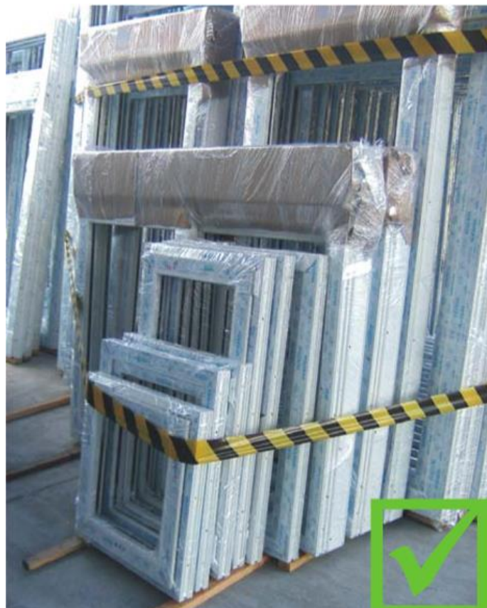
Figura 26 – Armazenamento de esquadrias de correr de perfis em PVC rígido. Imagem cedida pela WEIKU DO BRASIL
