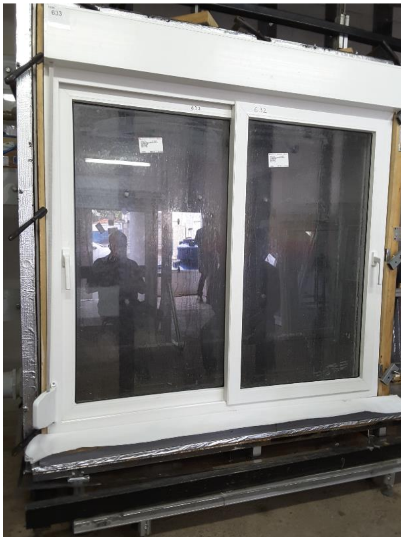
Figura 12 – Execução do ensaio de estanqueidade à água
