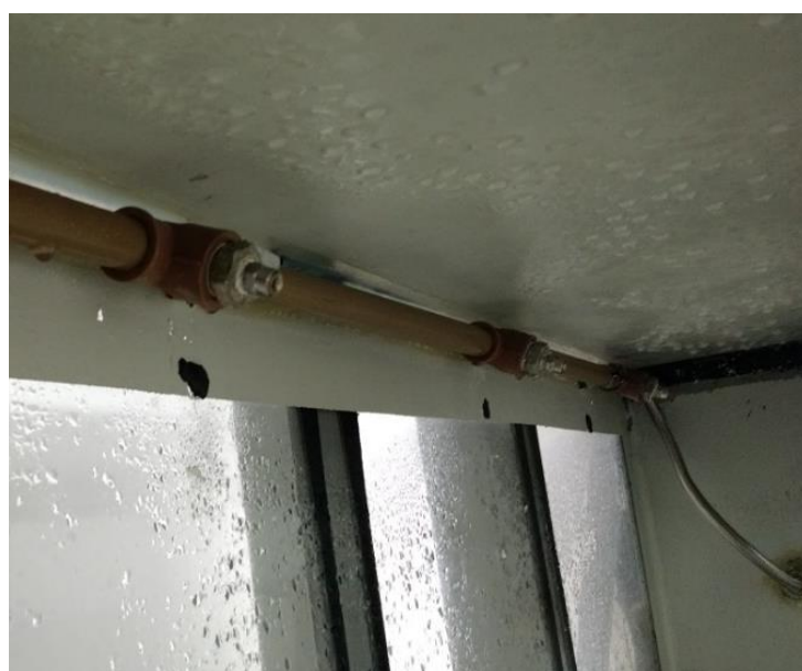
Figura 13 – Detalhe da aspersão do jato no ensaio de determinação da estanqueidade à água
