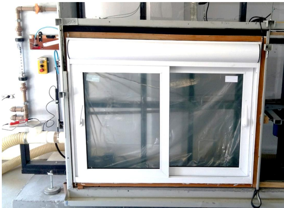
Figura 11 – Execução do ensaio de permeabilidade ao ar
