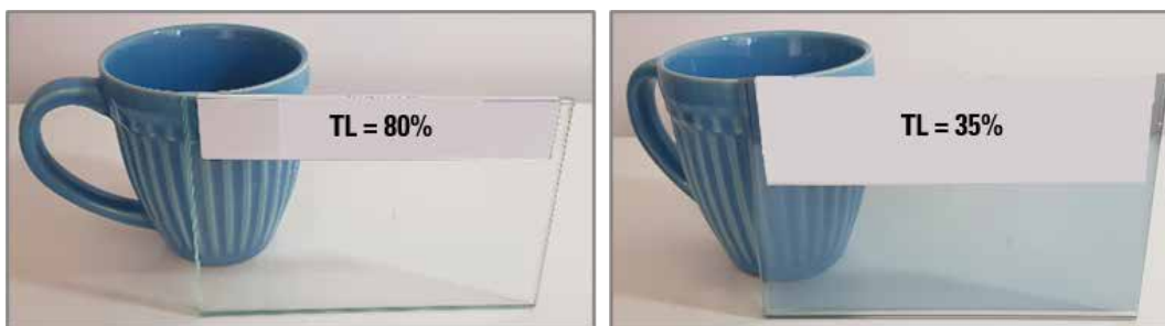
Figura 6: Comparativo entre um vidro incolor comum (esq.) com TL 0,80 e um vidro de controle solar (dir.) com TL 0,35.
